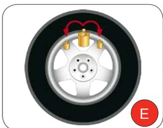
**PROGRAMME MASSE CACHÉE ET PLANS MOBILES (ALU P):** «Masse Cachée» divise le poids adhésif externe en 2 parties à placer derrière les rayons de la jante. Le programme «Plans Mobiles» calcule la position d'équilibre afin d'utiliser poids adhésifs de valeur multiple de 5 gr.
