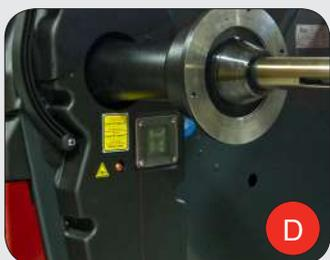
**LIGNE LASER ET ILLUMINATEUR JANTE:** Standard avec ligne Laser et illuminateur jante. La ligne Laser aide l'opérateur pendant le positionnement des poids adhésifs à 6 heures pendant l'usage des programmes ALU. L'illuminateur jante aide l'utilisateur pendant les phases de nettoyage jante et positionnement poids.
