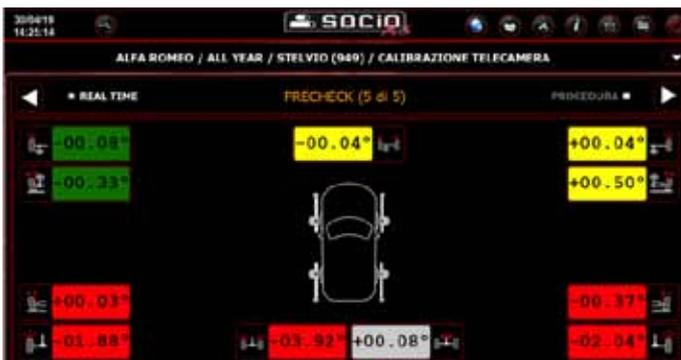
Software AllInOne : logiciel de diagnostic avec fonction de PreCheck pour le contrôle des valeurs de carrossage et parallélisme du véhicule selon les conditions requises par le constructeur.
