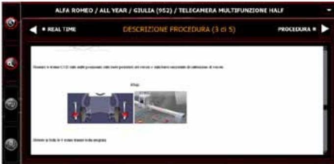
L'interface utilisateur guide l'opérateur lors des différentes procédures d'alignement du système.
