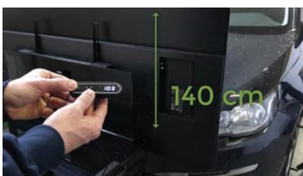
6. L'ÉTALONNAGE DÉMARRE. LE MONITEUR AFFICHERA LA CIBLE, EN L'ADAPTANT À LA POSITION DE LA VOITURE, GARANTISSANT AINSI LE RÉSULTAT LE PLUS PRÉCIS POSSIBLE.
