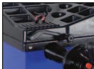
saisie des caractéristiques de la jante par le bras de mesure électronique équipé d'un réservoir de positionnement de masse d'équilibrage
